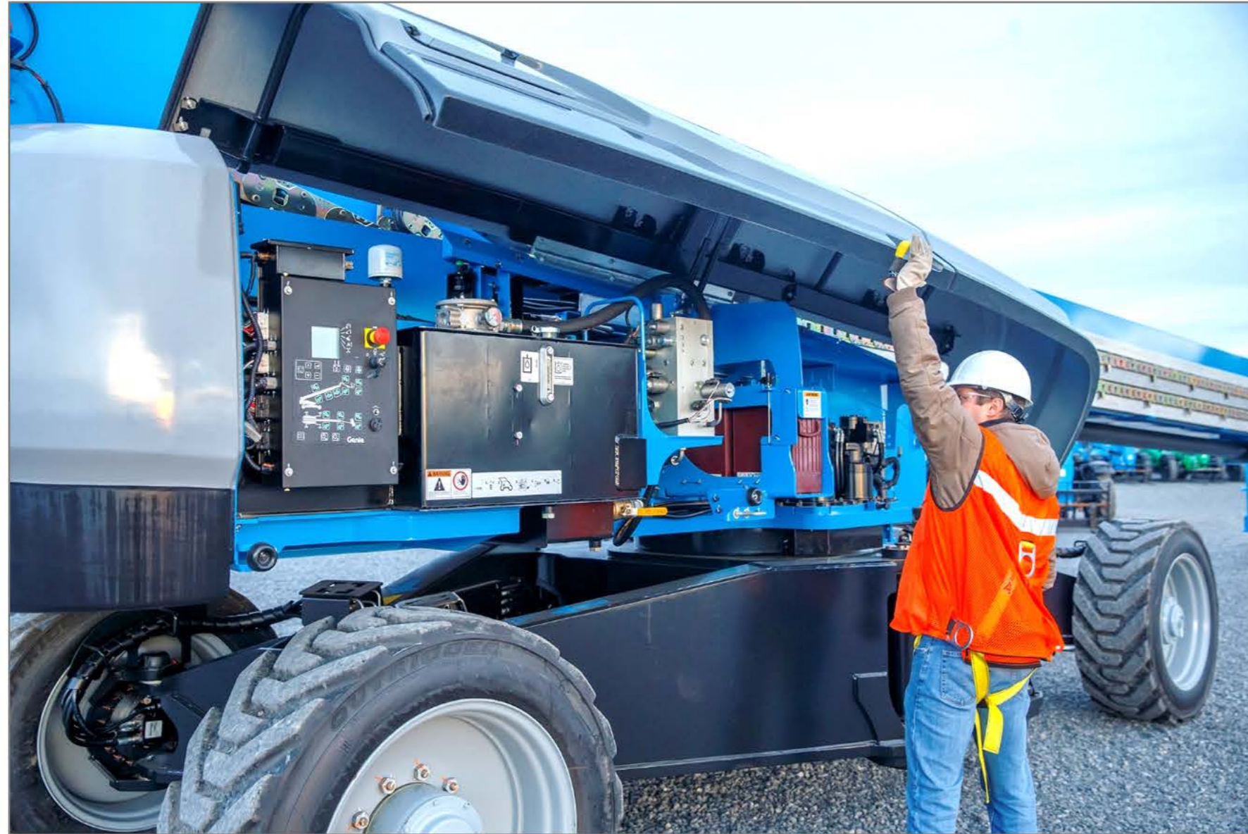
Tägliche Sicht- und Funktionsprüfung der Hubarbeitsbühne durch den Bediener
